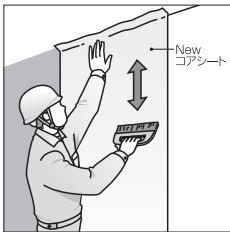
コアシート張り
